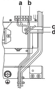
À fixer aux supports en plastique indiqués à l'aide de matériaux de fixation à fournir.
