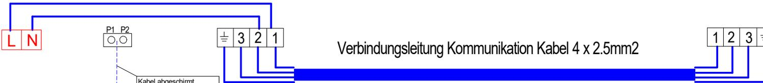
Verbindungsleitung Kommunikation Kabel 4 x 2.5mm<sup>2</sup>
