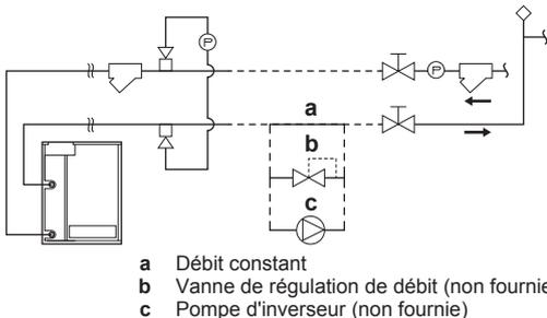
Un système peut soit être configuré comme système à débit constant (a), système à débit variable avec vanne (b) ou système à débit variable avec une pompe (c).
