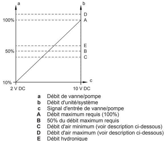
Suivez le critère de conception ci-dessous pour sélectionner la vanne correcte pour le système. Le débit maximum requis A du système de vanne est une propriété de la vanne fournie et le débit à 50% B est directement lié au débit maximum du système.
