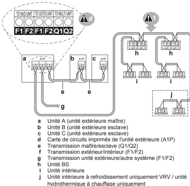
Le câblage d'interconnexion entre les unités extérieures d'un même système de tuyauterie doit être relié aux bornes Q1/Q2 (Out Multi). Le branchement de fils aux bornes F1/F2 entraîne un dysfonctionnement du système.
