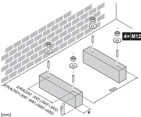
**a** Die Abflusslöcher der Bodenplatte der Einheit müssen frei sein.
