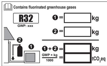
Gesamte Füllung = Werksseitige Füllung ①<sup>(a)</sup>+zusätzliche Füllmenge ②<sup>(b)</sup>
