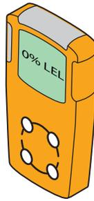
Un rilevatore LEL misura la presenza di un combustibile (ad esempio R290) e la quantità presente nell'aria (vol%). Se la miscela è compresa tra LEL e UEL e si genera una scintilla, può verificarsi un'esplosione.
