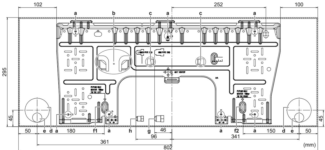
a Points de fixation recommandés pour la plaque de montage
