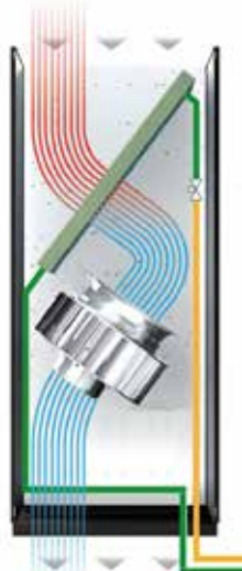
UDX: unità di climatizzazione ad espansione diretta con uscita verso il basso, da abbinare a un'unità condensazione esterna.
