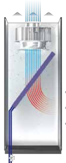
OCW: Uscita verso l'alto, acqua refrigerata
