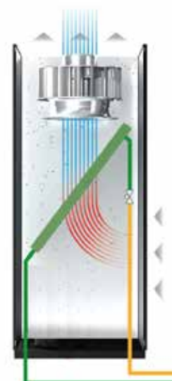
ODX: unità di climatizzazione ad espansione diretta con uscita verso l'alto, da abbinare a un'unità condensazione esterna.
