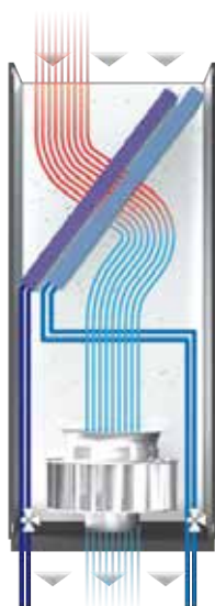
UDW: Uscita verso il basso, acqua refrigerata a doppio circuito
