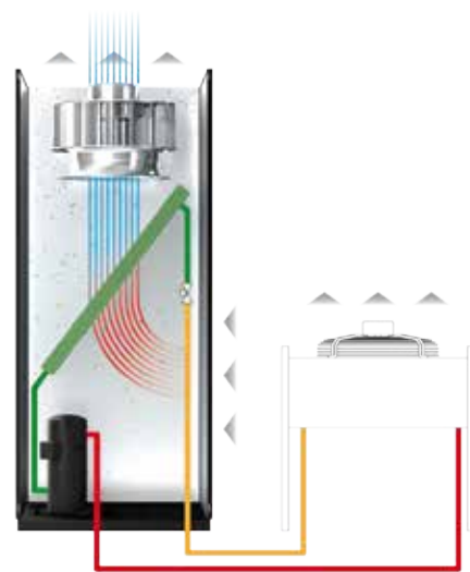
OEDA: Uscita verso l'alto, espansione diretta raffreddata ad aria
