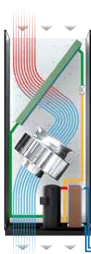
UEDW : Sortie vers le bas, expansion directe refroidie par eau
