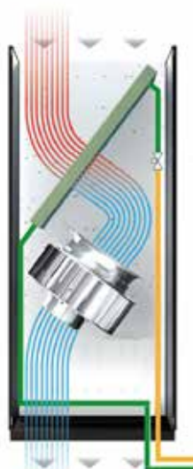
UDX : sortie vers le bas, unités de climatisation à détente directe pour la combinaison avec une unité de condensation externe
