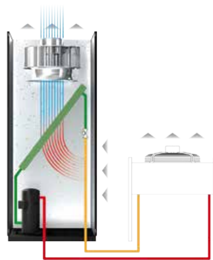
OEDA : Sortie vers le haut, expansion directe refroidie par air
