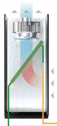
ODX : sortie vers le haut, unités de climatisation à détente directe pour combinaison avec une unité de condensation externe.
