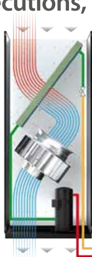
UEDA : Sortie vers le bas, expansion directe refroidie par air
