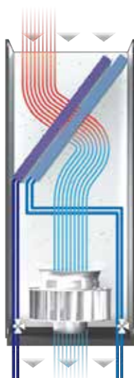
UDW : sortie vers le bas, eau froide double circuit
