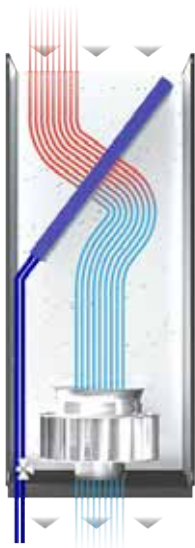
UCW: Auslass nach unten, gekühltes Wasser
