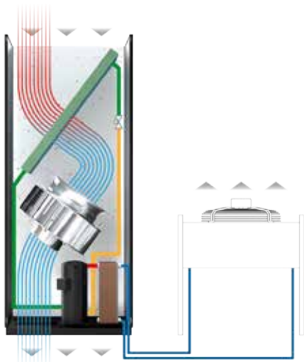
UEDW: Auslass nach unten, wassergekühlte Direktexpansion
