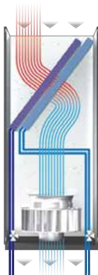
UDW: Auslass nach unten, gekühltes Wasser Doppelkreislauf
