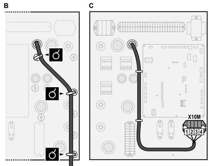
4 Fixieren Sie die Kabel mit Kabelbindern an den Kabelbinderhalterungen. Fixieren Sie bei Bedarf überschüssige Kabellänge mit einem Kabelbinder.
