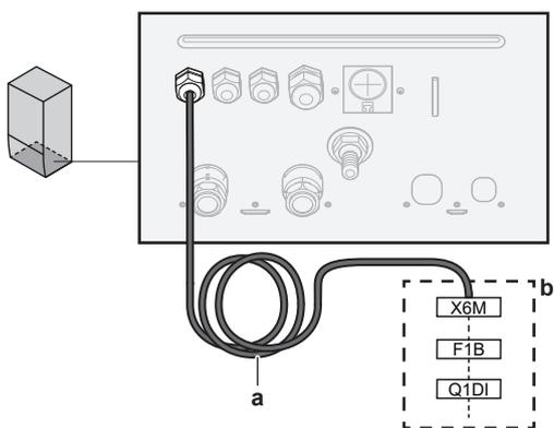
**a** Werkseitig montiertes Kabel verbunden mit dem Schaltschütz der Reserveheizung im Inneren des Schaltkastens (K5M)
