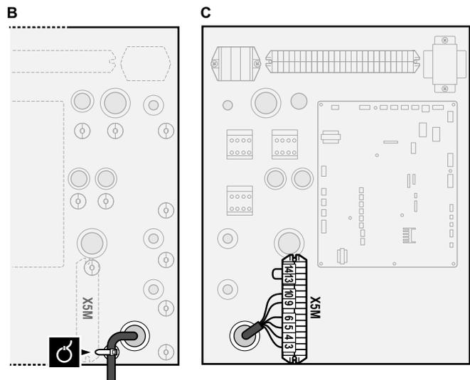
2 Fixieren Sie die Kabel mit Kabelbindern an den Kabelbinderhalterungen.
