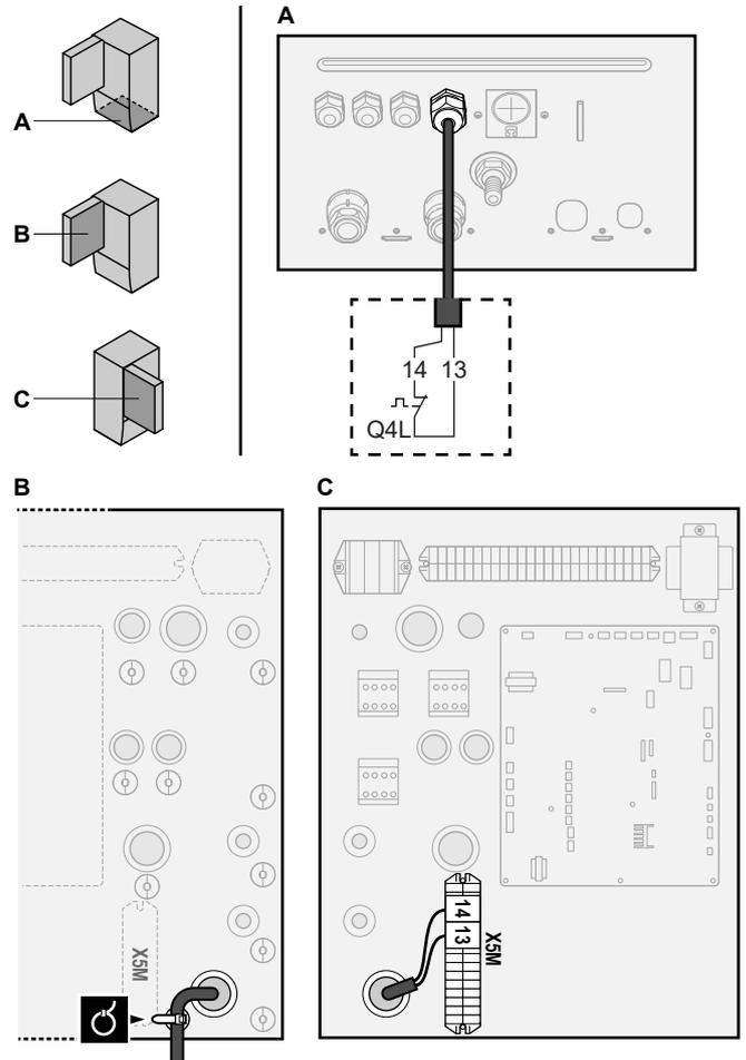
3 Befestigen Sie das Kabel mit Kabelbindern an den Kabelbinderhalterungen.
