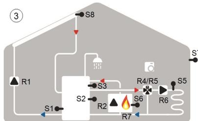
③ Accumulo combinato, solare e caldaia+
