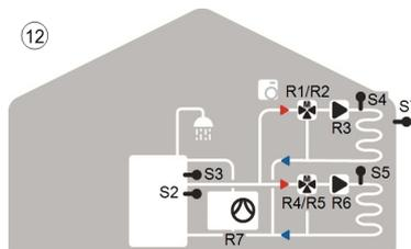
⑫ Accumulo combinato, 2 circuiti di riscaldamento misti e pompa di calore
