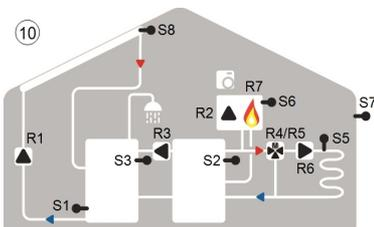
⑩ Solare, accumulo combinato, accumulo tampone e caldaia
