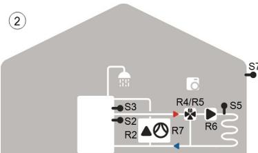
② Accumulo combinato, pompa di calore e pompa di carico
