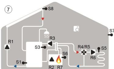
⑦ Solare e caldaia
