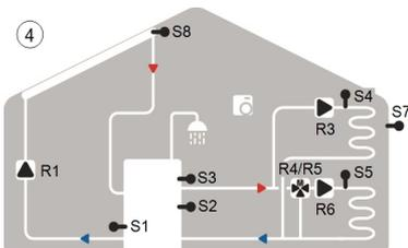
④ Accumulo combinato, solare e 2 circuiti di riscaldamento
