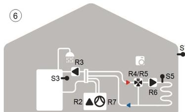
⑥ Accumulo combinato, pompa di calore e pompa di carico
