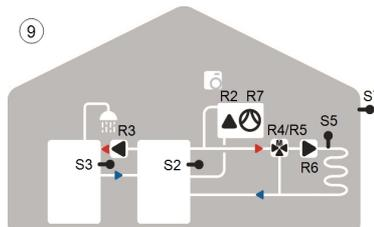
⑨ Accumulo combinato, accumulo tampone e pompa di calore
