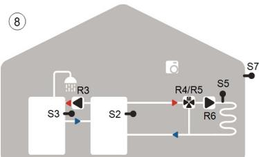
⑧ Accumulo combinato, accumulo tampone e circuito di riscaldamento
