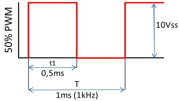
PWM: da 20% a 100%, 1kHz Progettato per un carico di 10K Ohm
