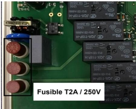
Si le régulateur, en dépit d'une tension réseau activée, ne fonctionnait plus ainsi que l'affichage, alors il serait possible que le fusible interne soit défectueux. Dans ce cas, veuillez ouvrir l'appareil selon les instructions données sous le point C, retirer le fusible et le contrôler.
