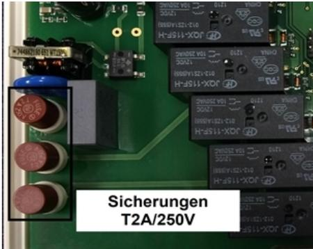
Hat der Regler trotz eingeschalteter Netzspannung keine Funktion und Anzeige, ist evtl. die interne Gerätesicherung defekt. Dann das Gerät wie unter C beschrieben öffnen, alte Sicherung entfernen und überprüfen.
