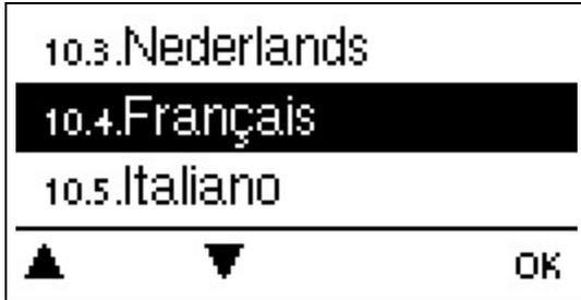
Ce menu permet de choisir la langue pour le pilotage des menus. Lors de la première mise en service et des coupures de courant prolongées, l'interrogation s'effectue automatiquement. Le choix des langues peuvent différer selon le modèle. La sélection de la langue n'est pas disponible pour tous les modèles.
