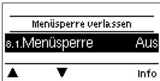
Durch aktivierte Menüsperr können die eingestellten Werte gegen unbeabsichtigtes Verstellen gesichert werden.
