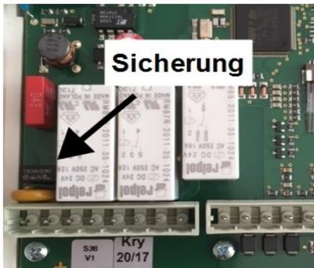
Hat der Regler trotz eingeschalteter Netzspannung keine Funktion und Anzeige, ist evtl. die interne Gerätesicherung defekt. Zuerst die externe Fehlerquelle (wie z.B. Pumpe) finden, austauschen und danach die Gerätesicherung überprüfen.
