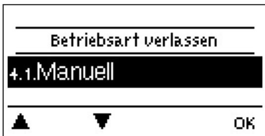
Zur Festlegung der Betriebsarten für den Heizkreisbetrieb. Nach einer Netzspannungsunterbrechung kehrt der Regler selbstständig in die zuletzt gewählte Betriebsart zurück!
