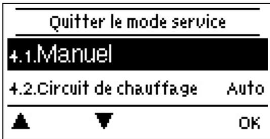
Pour fixer les modes de service du fonctionnement de l'installation. Après une coupure de courant le contrôleur revient au dernier réglage du mode de service !
