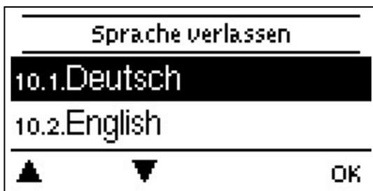
Zur Wahl der Menüsprache. Bei der ersten Inbetriebnahme und bei längerer Spannungsunterbrechung erfolgt die Abfrage automatisch. Die wählbaren Sprachen können sich je nach Geräteausführung unterscheiden! Die Sprachwahl ist nicht in jeder Geräteausführung vorhanden!
