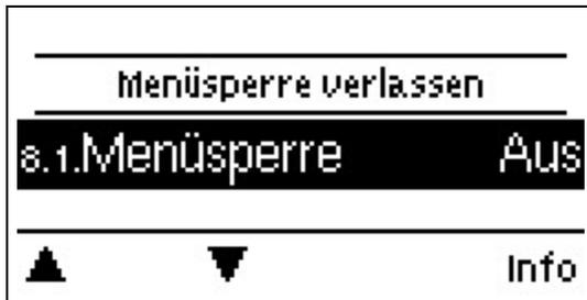
Durch aktivierte Menüsperre können die eingestellten Werte gegen unbeabsichtigtes Verstellen gesichert werden.
