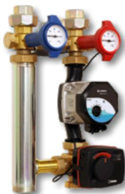
Kompakte Pumpen- Mischergruppe zur Festwertregelung der Vorlauftemperatur elektronisch geregelt. Einstellbereich: 5-95 °C<sup>1)</sup>. 3-teilige patentierte EPP-Isolierschale, Wärmedämmung nach GEG. Inkl. Wandhalterung, Befestigung und 2 Verschraubungen.
