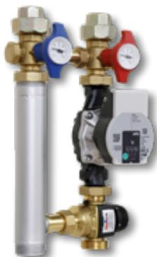
Kompakte Pumpen- Mischergruppe zur Festwertregelung der Vorlauftemperatur thermostatisch geregelt. Einstellbereich: 20-55 °C oder 30-70 °C. 3-teilige patentierte EPP-Isolierschale, Wärmedämmung nach GEG. Inkl. Wandhalterung, Befestigung und 2 Verschraubungen.
