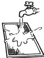
Wenn der Luftfilter sehr verschmutzt ist, verwenden Sie eine weiche Bürste und neutrales Waschmittel. Das Wasser abwischen, und im Schatten trocknen lassen.
