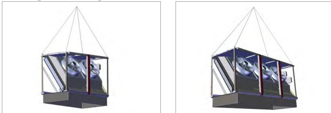
Fig. 5: Opzione di trasporto consigliata per l'evaporatore esterno
