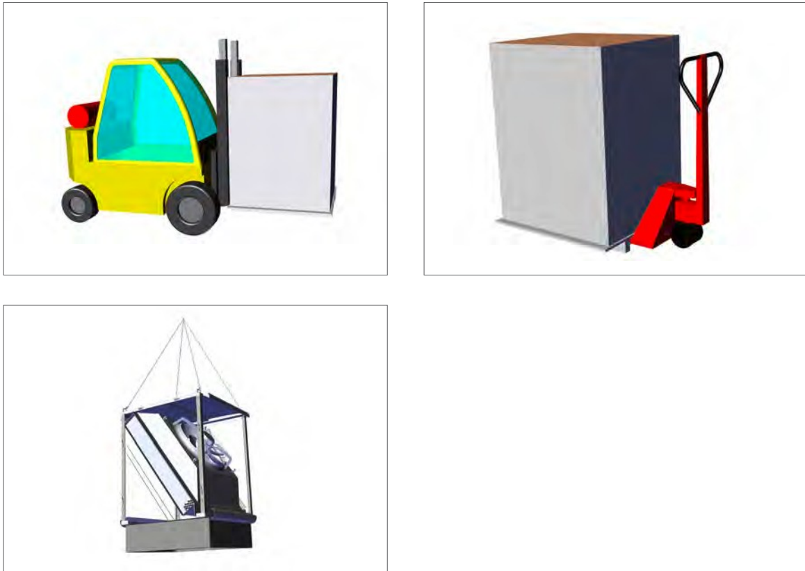
Fig. 5: Variantes de transport recommandées pour l'évaporateur extérieur (engin de levage uniquement Silent Source 80 et 120)
