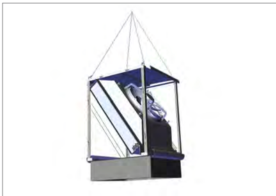
Abb. 5: Empfohlene Transportvarianten für den Außenluftverdampfer (Kran nur Silent Source 80 und 120)
