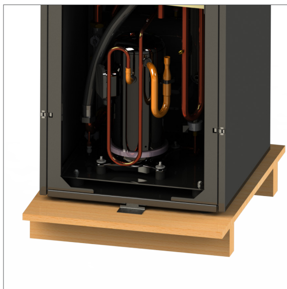
Abb. 7: Verkleidungselemente demontieren: Display am Deckel entfernen, unteren Teil der Verkleidung von der Luft/Wasser Wärmepumpe wegziehen und nach oben wegheben.
