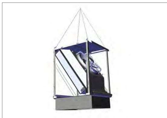
Fig. 8: Varianti di trasporto consigliate per la pompa di calore
