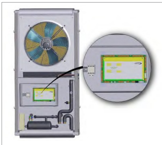
Fig. 12: Collegamento elettrico della pompa di calore
