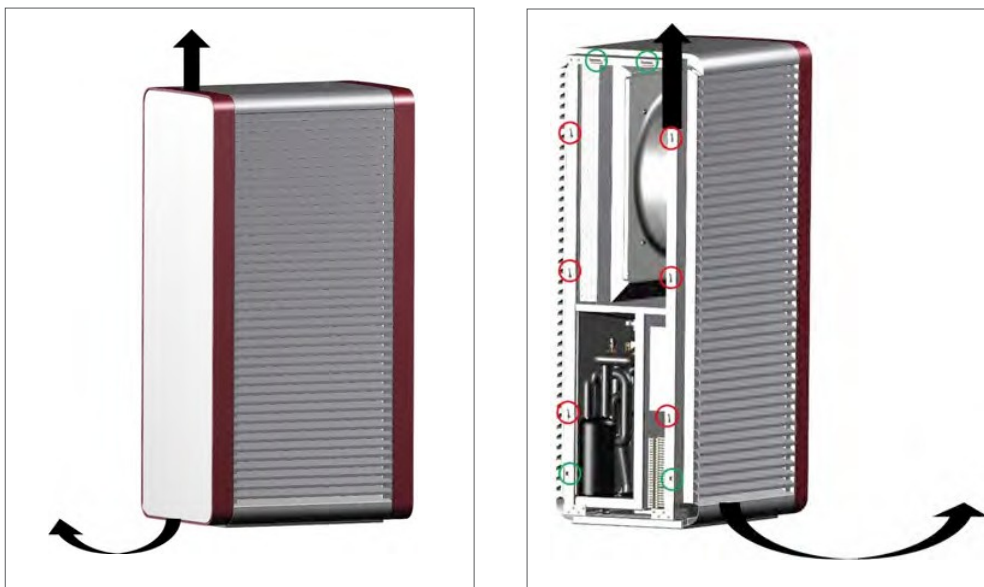
Fig. 4: Rimozione del rivestimento
