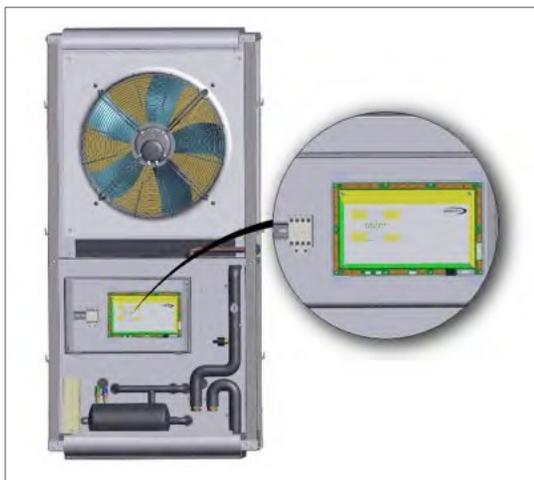
Fig. 12: Raccordement électrique dans la pompe à chaleur
