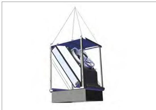
Fig. 8: Variantes de transport recommandées pour la pompe à chaleur
