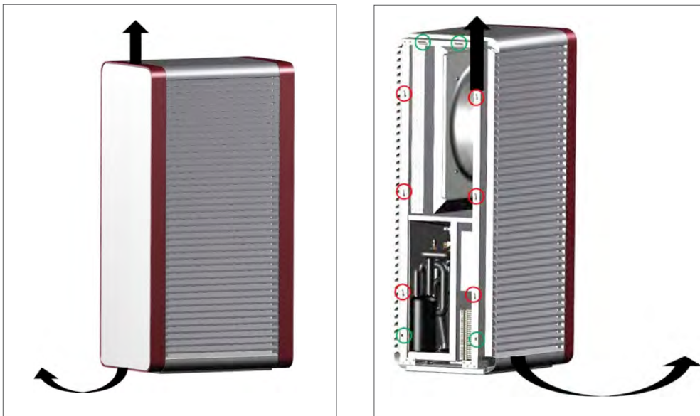
Abb. 4: Entfernen der Verkleidung
