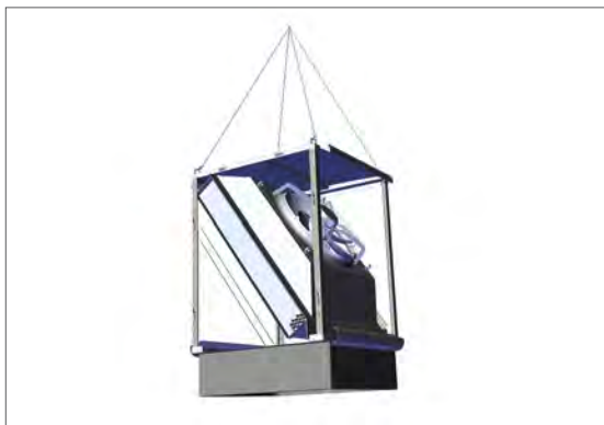
Abb. 8: Empfohlene Transportvarianten für die Wärmepumpe
