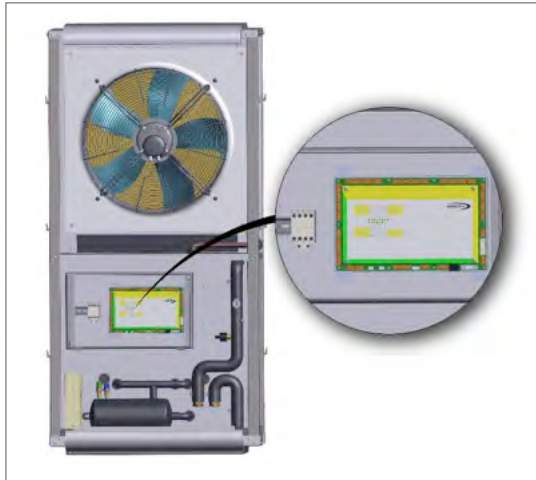
Abb. 12: Elektrische Anschluss in der Wärmepumpe
