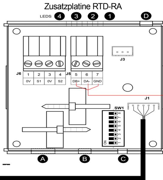
Platzierung der Zusatzplatine RTD-RA mit der Installationsbox KRP4AA93
