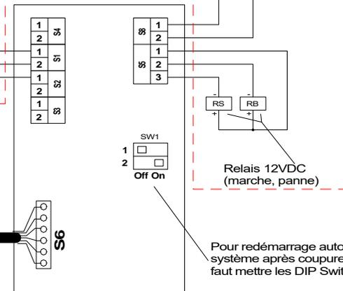
Pour redémarrage automatique du système après coupure du courant il faut mettre les DIP Switch selon l'image
