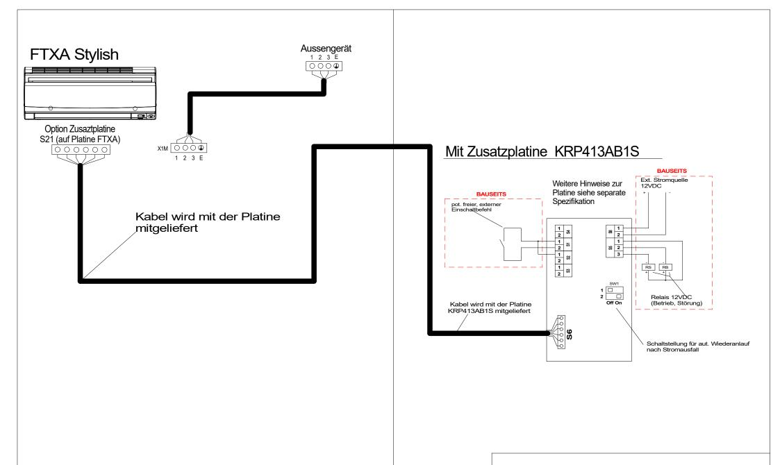
Prinzipschema Option Zusatzplatine mit 12V Signal
