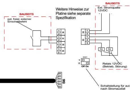
Kabel wird mit der Platine KRP413 AB1S mitgeliefert
